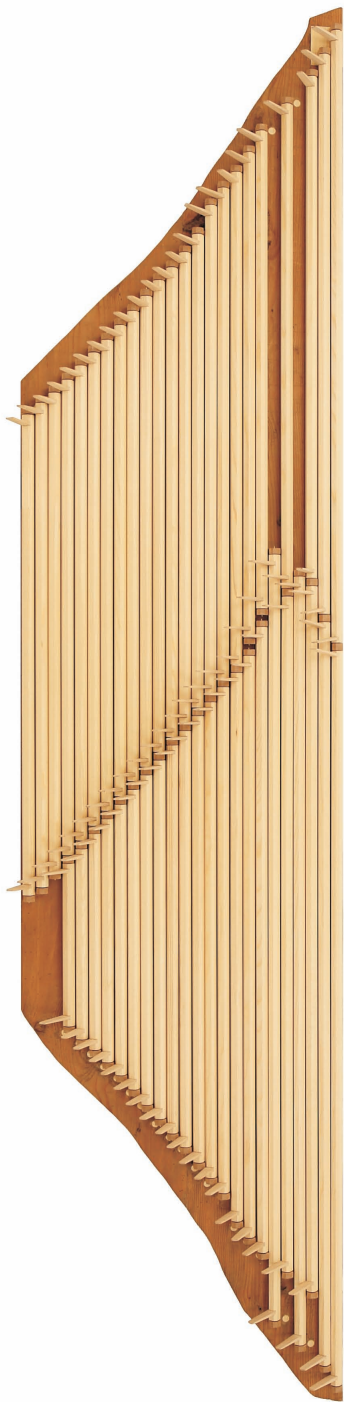
Hřídelnice manuálu po rekonstrukci
