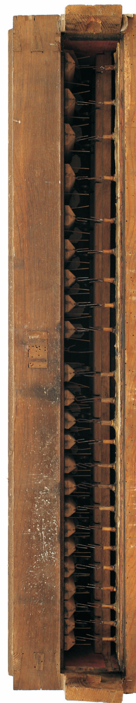
Manuálová vzdušnice s otevřenou ventilovou komorou před restaurováním
