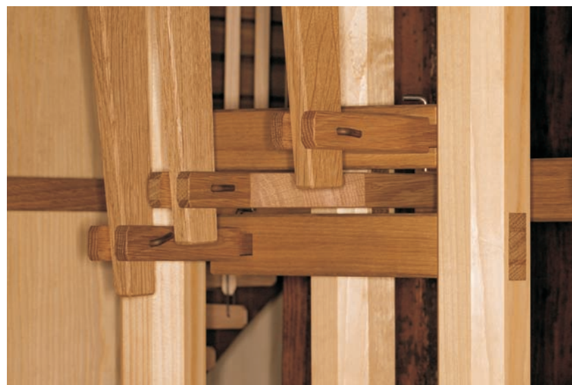
Detail registratury po rekonstrukci
