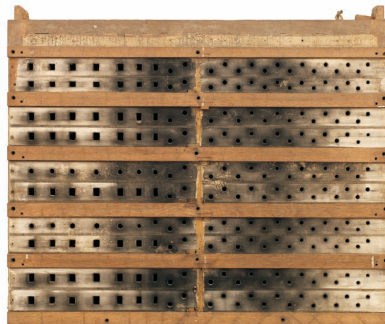
Horní plocha vzdušnice manuálu před restaurováním
