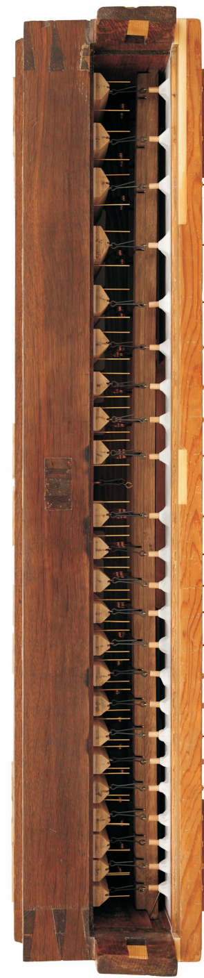
Manuálová vzdušnice s otevřenou ventilovou komorou po restaurování
