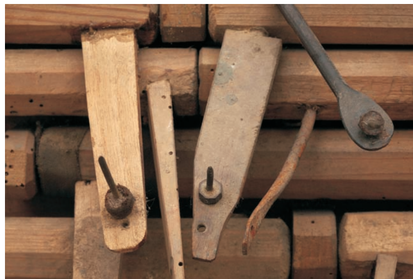
Detail hřidelové desky manuálu před rekonstrukcí
